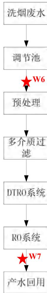
图 7.1-4 脱酸废水处理系统监测点位示意图
