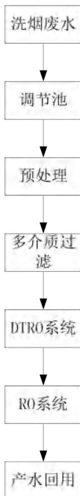
图 4.1-2 湿法脱酸废水处理系统工艺流程图
