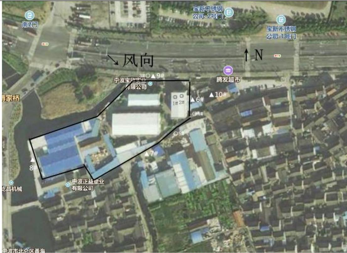
◎-有组织废气采样点；○-无组织废气采样点；▲-工业企业厂界噪声检测点
